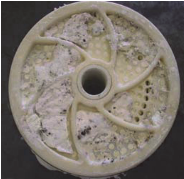
Abbildung 2-11 Scaling auf einer Umkehrosmosemembran; Quelle: http://www.lenntech.com/
